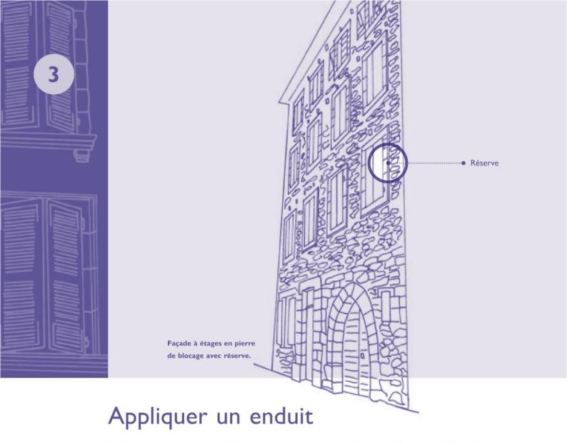
L'étude technique et stylistique d'un mur est indispensable pour définir le projet d'une façade. Un enduit répond à un style, protège un matériau sans le dégrader et harmonise un ensemble. Il doit avoir un grain, une couleur et une méthode d'application conformes à l'architecture de l'édifice.
